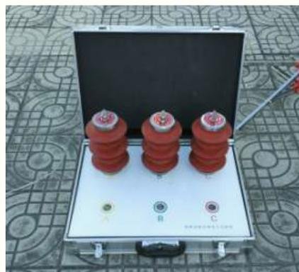
图8 避雷器停电试验专用支架现场使用图
