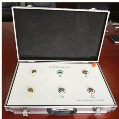
图7 避雷器停电试验支架实物图
