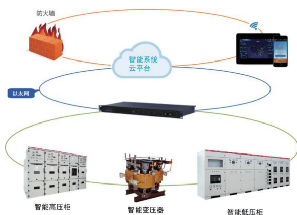
图1 配电房智能化改造构架图
