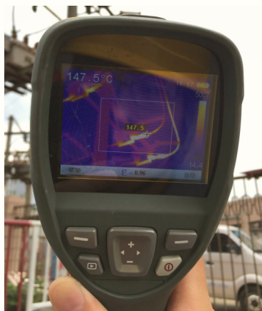
图1 隔离开关测温结果
