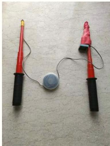
图3 低压母线槽核相器实物图
