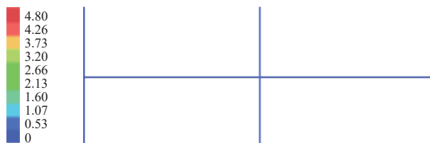
图6 竖向地震工况轴力云图 (kN)
