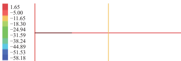
图11 组合 9: 1.2 \times 重力荷载代表值效应+ 1.3 \times X向地震+ 0.5 \times 竖向地震轴力云图 (kN)
