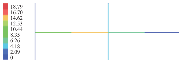
图7 恒荷载（含自重）工况位移云图 (mm)
