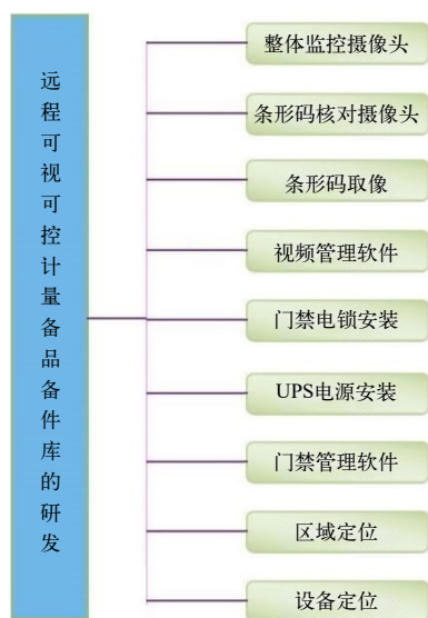
图1 远程可视可控计量备品备件库系统框图
