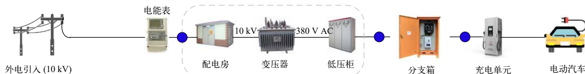
图 3 电动汽车与充电设备在配电网中的连接图
