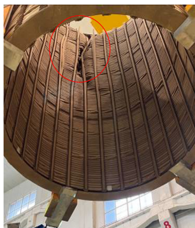
图8 A相中压绕组撑条分层情况
